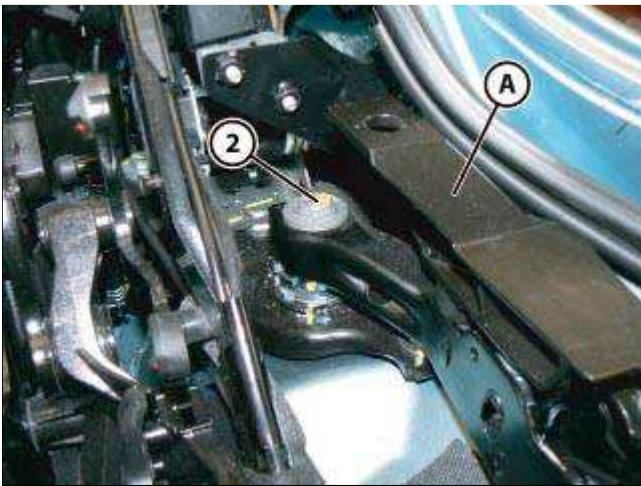
■ 拧紧右侧座后搁物板运动机构 (A) 的前部紧固螺钉 (2)。
