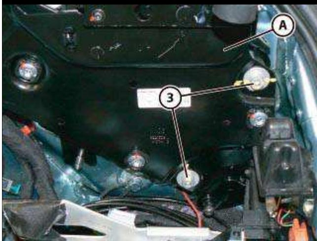
● 松开紧固座后搁物板运动机构 (A) 的两个后部螺钉 (3)。
