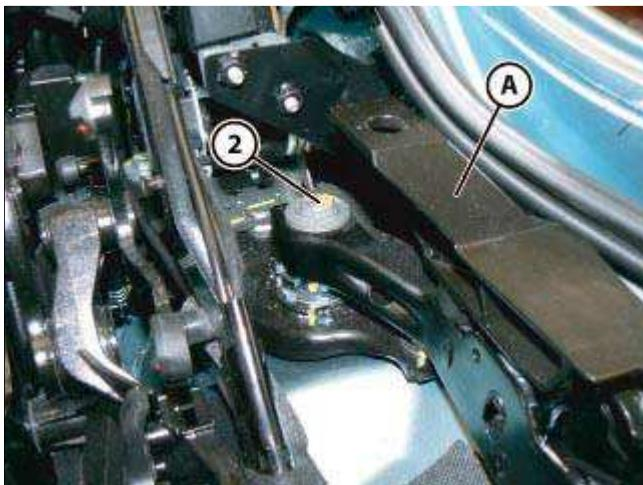
● 松开紧固座后搁物板运动机构 (A) 的前部紧固螺钉 (2)。
